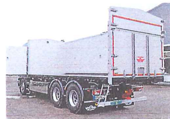
Smidig Orykonstruktion för spannmålsbilar med kran. Samtliga sidodörrar viks framåt.
