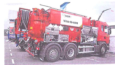
Slamsugare från Nordic Tank med spoltillsats och ecostyrning.
