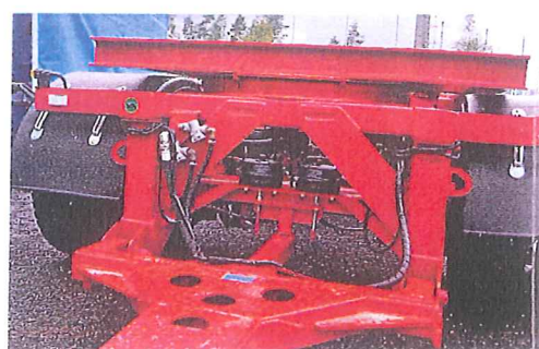
Bromsklockorna har nu fått en mer skyddad placering på Norsleps lastväxlarvagn.
